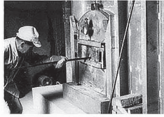
加熱中の素材を鉄製のこで整形
