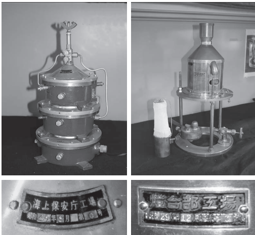
右：石油灯器と燈台部工場（昭和29年製）銘板 左：ガス灯器と經理補給部工場（同42年製）銘板
